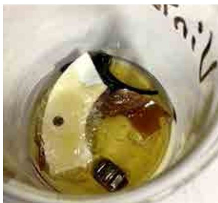
Delar av gummidetaljer, impeller, backventil, flera O-ringar med mera under behandling: 30 minuter i koncentrerad Transclean65 samt ytterligare 6 timmar i Transclean65 utspädd till bara 10-procent.
