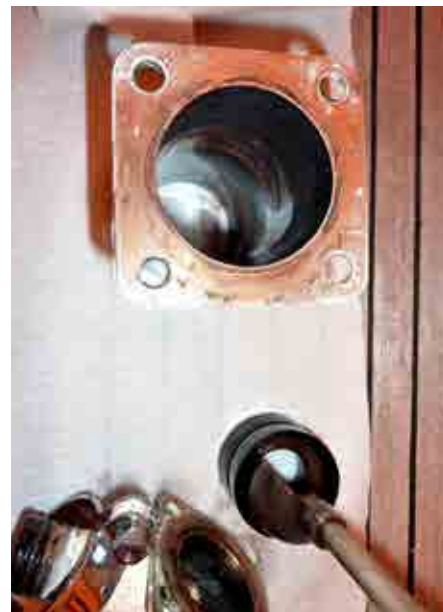
Delar efter 30 minuter i koncentrerad Transclean65 samt ytterligare 6 timmar i utspädd, 50-procentig Transclean65.
